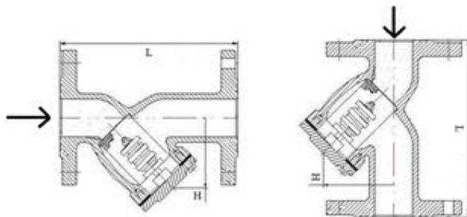
7.2 Монтаж фильтров производить между фланцами, изготовленными по **ГОСТ 33259-2015**.
